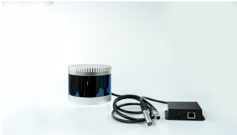
图 2.3 接线盒与雷达连接示意图（上为标准接头，下为航空对插线头）
