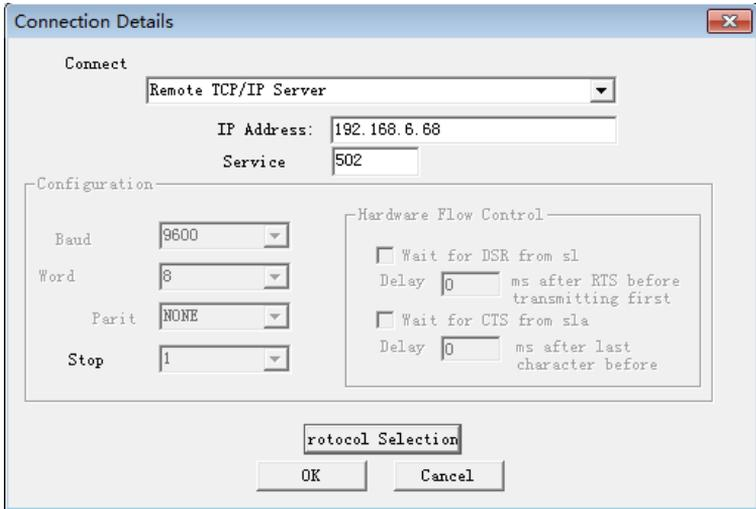
先点击 protocol selection 配置连接参数，再点击 OK 完成配置并连接机器人
